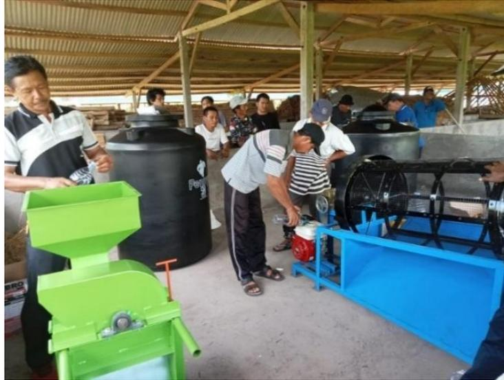
**Gambar 4. Mesin Pemotong Limbah Organik (warna Hijau) dan Mesin Pengayak (warna Biru) untuk Pembuatan Pupuk Organik Padat**
