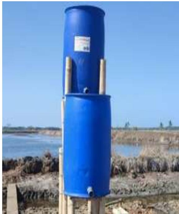
**Gambar 4. Penyaring bertingkat untuk air baku pembuatan garam**
