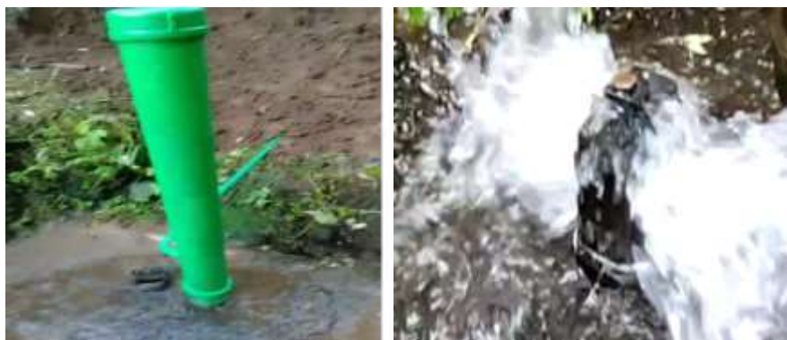
Gambar 7. Pompa Hidram Dengan Debit 0,5 Liter/Detik
